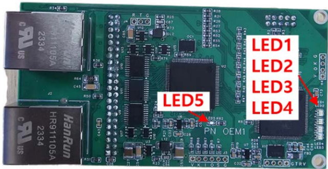
图 2.1.1 Profi-NET通信卡及连接器
