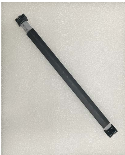
图 10.3-4 控制板和键盘的连接线
